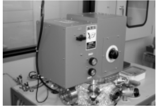
写真2 薄膜を作るためのスパッタリング装置
