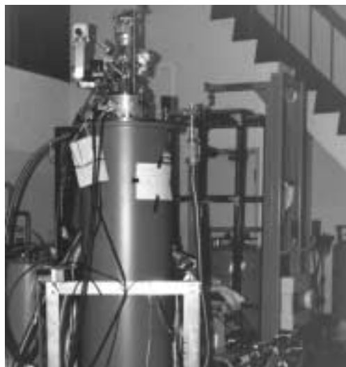
センターにある実験装置の一つ 0.01Kの極低温、17テスラの強磁場を作り出す
